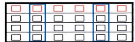
LP : 3806 à 5000 mm 6 hublots (en option) portillon déporté à droite ou à gauche
